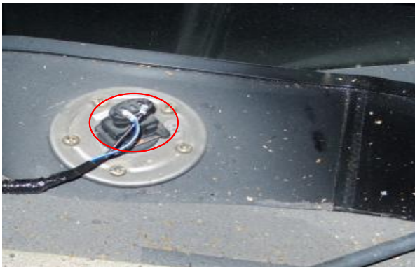
Расположение датчика уровня топлива находится на верхней части топливного бака в отсеке бака.
