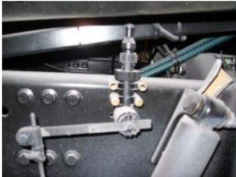
Датчик высоты передней подвески крепится с правой стороны главной балки над передним мостом.
