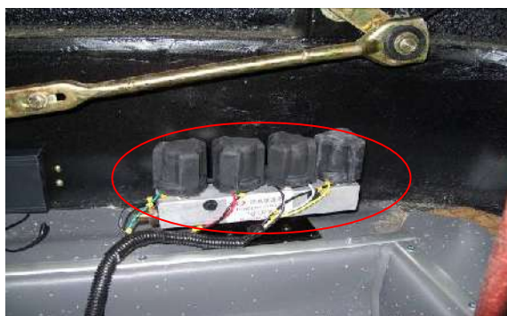
Напорный выключатель ретардера находится в панели приборов вблизи дефростера
